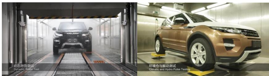
图 13 动态淋雨测试及环境仓与振动测试
